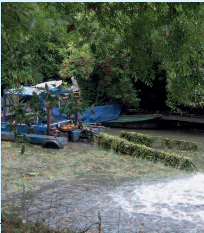
Hydro-venturi boot verwijdert waterwaaier (foto: Waterschap Rivierenland).
